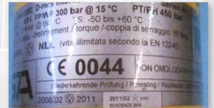
Le bombole che hanno superato la fase di collaudo vengono etichettate con la data di revisione e di scadenza.
