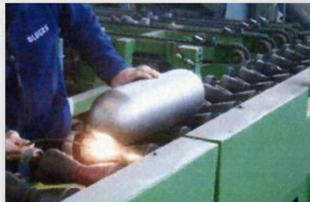
Viene quindi verificato lo stato interno del recipiente. Per le bombole in acciaio una seconda ispezione avviene dopo avere sabbiato internamente il recipiente, mentre per le bombole in alluminio l'ispezione avviene dopo il lavaggio.
