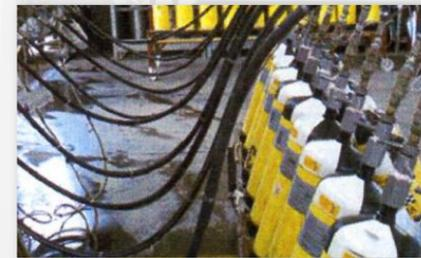
Tutti i recipienti vengono sottoposti alla prova in pressione per mezzo di un secondo impianto dove i parametri di processo sono monitorati dall'operatore attraverso le indicazioni di diversi manometri. Le bombole vengono riempite esclusivamente con acqua potabile non riciclata.
